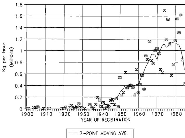
FIGURE 4. AVERAGE CAPACITY OF BOILERS BY YEAR OF REGISTRATION
