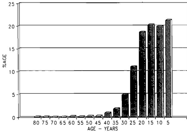
FIGURE 3. TOTAL CAPACITY OF BOILERS IN 1986, BY YEAR OF REGISTRATION
